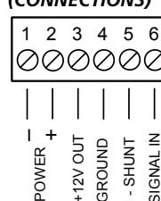
Bei Strommessung sind Klemmen 5+6 zu Brücken und gegen Klemme 4 das Stromsignal anzulegen.
